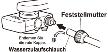
**Schritt 3** Führen Sie den Schlauch in den Zweigstecker ein und sichern Sie ihn, indem Sie die Feststellmutter festziehen.
