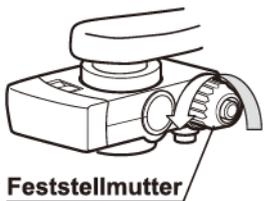
**Schritt 2** Bringen Sie die Feststellmutter über dem Schlauch an und bringen Sie anschließend den Schlauch am Ableitblech an.
