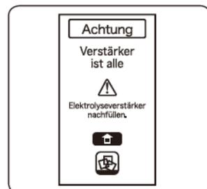
Diese Meldung wird angezeigt, wenn der Elektrolyse-Verstärker verbraucht ist, während stark saures Wasser hergestellt wird, oder wenn kein Elektrolyse-Verstärker im Tank ist.
