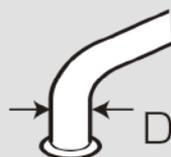
Mesurez la dimension D, puis sélectionnez l'un des trois anneaux de fixation (16 · 17,5 · 19 mm).
