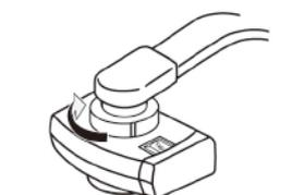
Serrer l'écrou de fixation.
