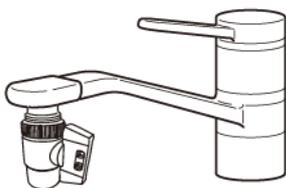
Dans le cas du déviateur avec la douche Retirer l'écrou de fixation.
