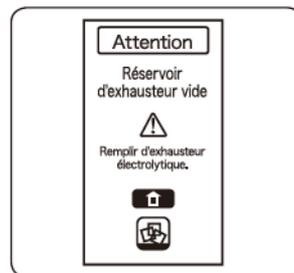
Ce message s'affiche lorsque l'exhausteur électrolytique est utilisé pendant que l'eau acide puissante est produite, ou lorsqu'il n'y a pas non d'exhausteur électrolytique dans le réservoir.
