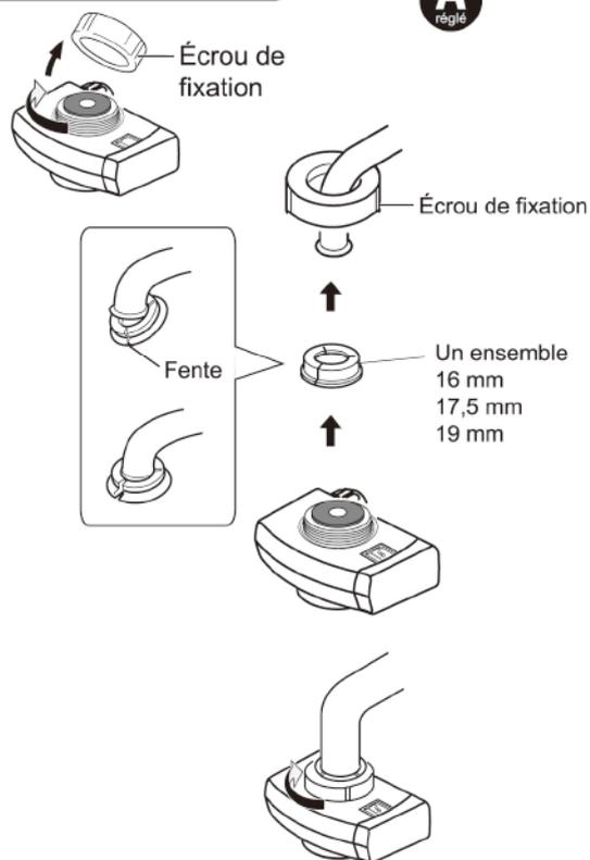
Serrer l'écrou de fixation.
