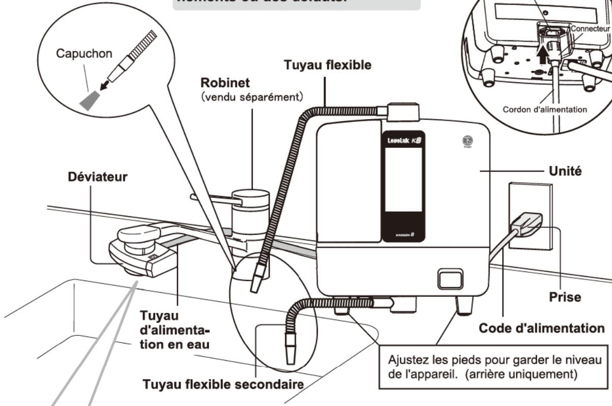
**!** Assurez-vous toujours d'insérer fermement le connecteur jusqu'au fond. Cela peut causer des dysfonctionnements ou des défauts.
