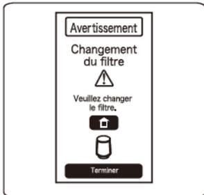
Lorsque le filtre à eau doit être remplacé.
