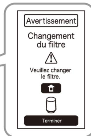
\*Remplacez le filtre si l'eau sent étrangement ou a un goût étrange, même si une notification vous invitant à remplacer le filtre n'est pas émise.
