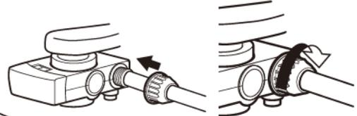
**!** N'utilisez pas un outil pour serrer l'écrou de fixation car cela pourrait entraîner la rupture de l'écrou.
