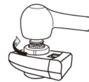
Serrer l'écrou de fixation.
