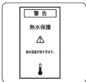
**40°C以上**の熱水が流され、熱水保護装置が働いた時、表示されます。
