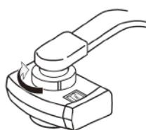
取り付けナットをしっかりと締め付ける。
