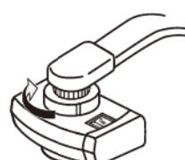
取り付けナットをしっかりと締め付ける。
