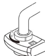
取り付けナットをしっかりと締め付ける。
