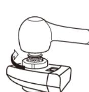
取り付けナットをしっかりと締め付ける。
