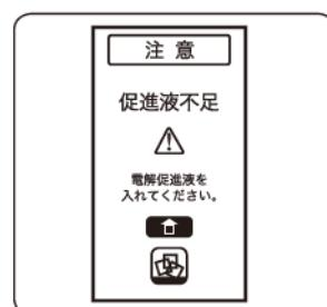
強酸性水生成中に電解促進液が無くなった時、または電解促進液が入っていない時、表示されます。
