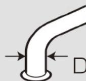
Meça a dimensão D e selecione um dos três anéis de fixação (16 · 17,5 · 19 mm).
