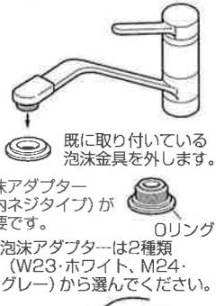
! ネジ部分を取り付ける際、ネジ径、ネジピッチ(ネジ山間隔)が合っていない場合、取り付け部のネジが破損する事があります。ネジ径、ネジピッチは正しくご確認ください。
