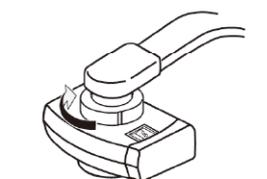
Serrer l'écrou de fixation.
