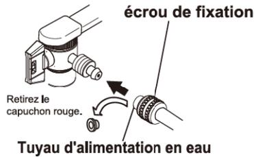
étape **3** Insérez le tuyau dans la prise de branche et fixez-le en serrant l'écrou de fixation.
