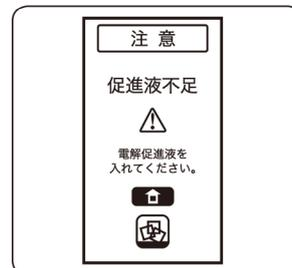
強酸性水生成中に電解促進液が無くなった時、または電解促進液が入っていない時、表示されます。
