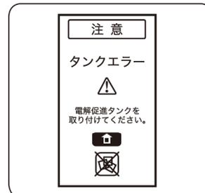
電解促進タンクが取り付けられていない時、表示されます。
