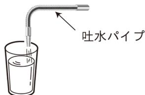
**2** pH試験紙を静かに浸し、すぐに引き上げる(1秒以内)。軽くふって余分な水分を落とす。
