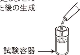
**2** pH試験液を1~2滴加え、よく振って混ぜ合わせてください。
