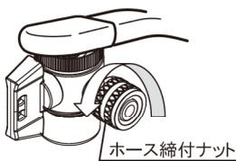
**2** 給水ホースにホース締付ナットを通し、分岐栓に差し込む
