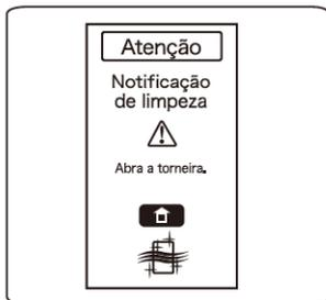
Esta mensagem é apresentada quando a limpeza for para ser executada no início da próxima operação de processamento de água.
