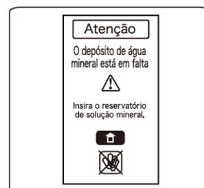
Esta mensagem é apresentada quando o **depósito da solução mineral** não está instalado.
