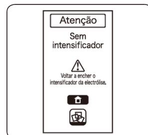
Esta mensagem é apresentada quando o intensificador da electrólise acabar enquanto a água ácida forte estiver a ser feita ou quando não há intensificador da electrólise no depósito.
