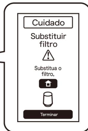
\*Substitua o filtro se a água cheirar mal ou se tiver um sabor estranho, mesmo se não houver uma notificação a instruí-lo para substituir o filtro.
