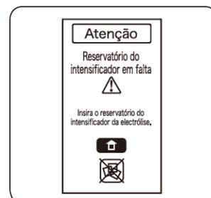
Esta mensagem é apresentada quando o **depósito do intensificador da electrólise** não está instalado.
